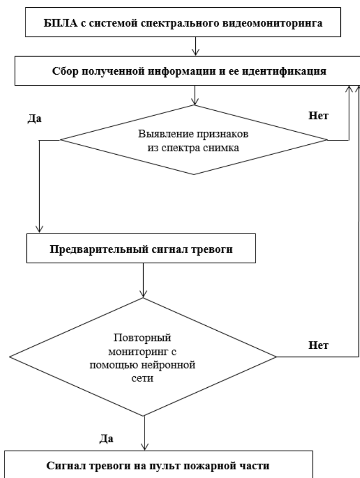
Рисунок 2 – Алгоритм обнаружения пожаров средствами БПЛА
